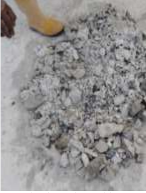
(1) تبدأ برش قليل من الماء على القضاض وتركه يتفاعل مع ماء بعض من الوقت.
