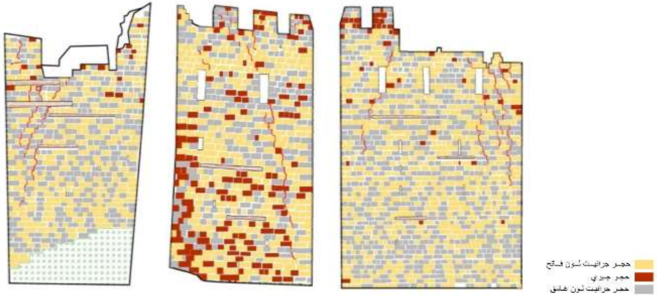
الشكل 11: يوضح أنواع الحجارة المستخدمة في واجهات البرج الغربي
